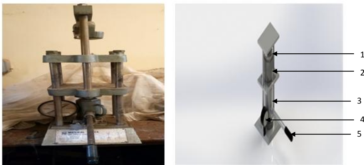
1 : Plunger ; 2 : pressing chamber ; 3 : hydraulic piston ; 4 : pressure gauge ; 5 : hand pressure
