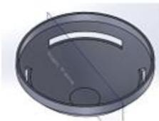
**Figure 9a:** Slit-cup separator
