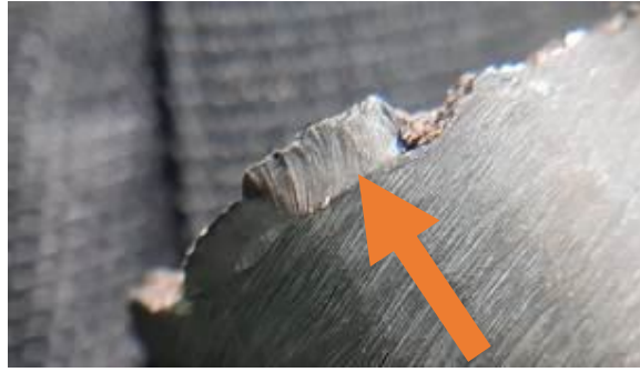
Foto 10 – Vista da região com deformação plástica onde ocorreu o início da ruptura.
