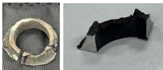
Foto 07 – Detalhe do corte transversal no corpo de prova da região da solda do tie-in onde ocorreu a deformação plástica (início da ruptura).
