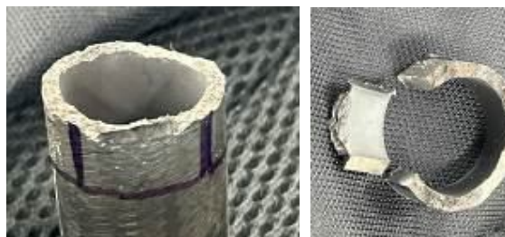
Foto 08 – Detalhe do corte transversal no corpo de prova da região do tubo de 3/4” do tie-in onde ocorreu a deformação plásticas (início da ruptura).
